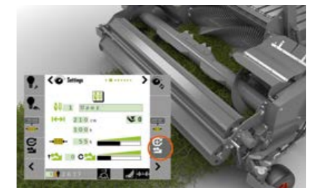
L'operatore può invertire facilmente la direzione del POWER FEEDING SYSTEM dalla cabina.
