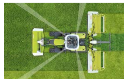
Grazie alla particolare disposizione dei montanti posteriori e al vetro posteriore bombato, l'operatore ha un'ottima visuale sull'attrezzo di lavoro e sugli attacchi.
