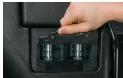
I poli esterni della batteria sono accessibili direttamente sul lato sinistro della scaletta d'accesso.
