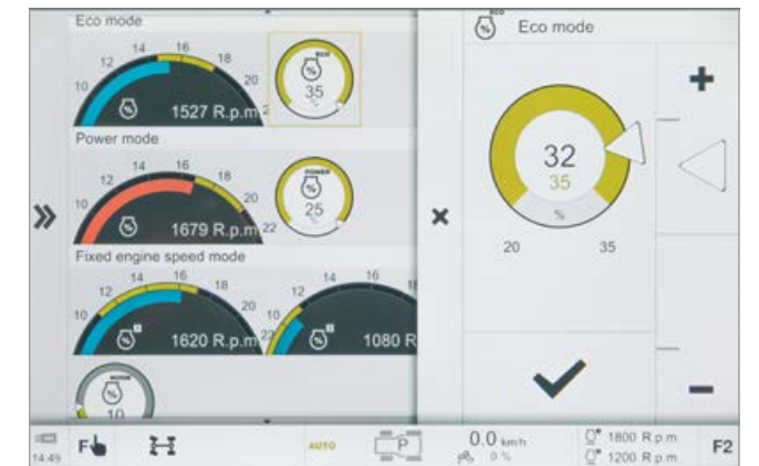
Impostazione del carico del motore per i valori «Eco» e «Power» e della memoria regime motore.
