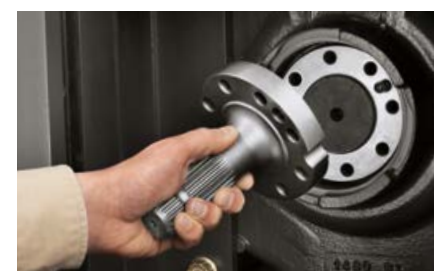
Facile sostituzione del codolo della presa di forza.
