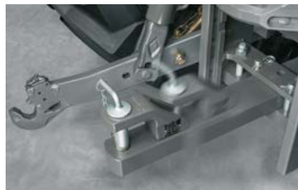
Le varianti di barra di traino mettono a disposizione diverse posizioni. La posizione allungata aumenta la manovrabilità.
