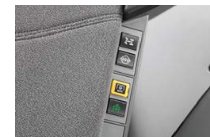
Attivazione della sospensione dell'assale anteriore.
