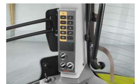
Velocità della presa di forza e regolazione elettronica del sollevatore regolabili sul montante B.
