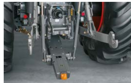
Un attacco con gancio pick-up è un'alternativa al dispositivo d'aggancio conforme alla norma ISO 500.
